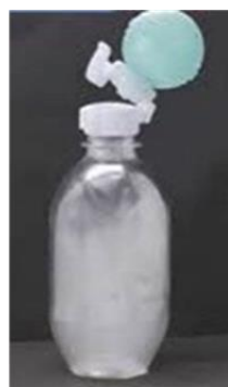
図 3 雲発生装置 (2) 緑色のポンプ部分
