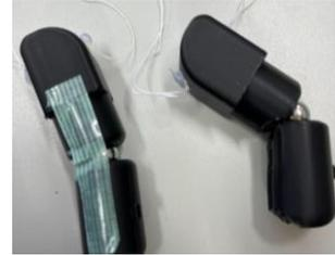
写真 3. 球関節を用いた指と関節部分
