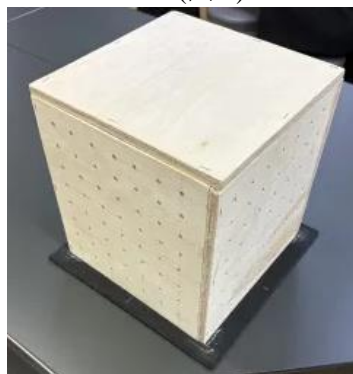
図 1 音源の周りに有孔ボードを置いた様子
