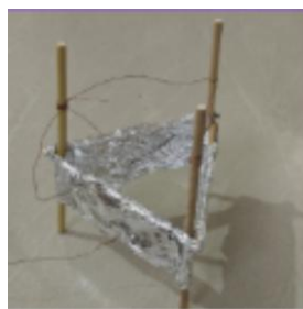
図 7 実際に制作したイオンクラフト
